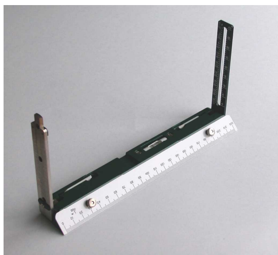
〔写真2〕 平板測量に使われるアリダード
